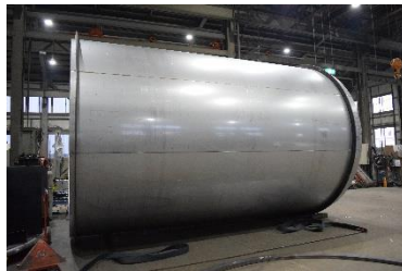
▲取材時は約2か月をかけて、200tの牛乳を貯める直径4m、高さ22mのタンクを作っていました。
